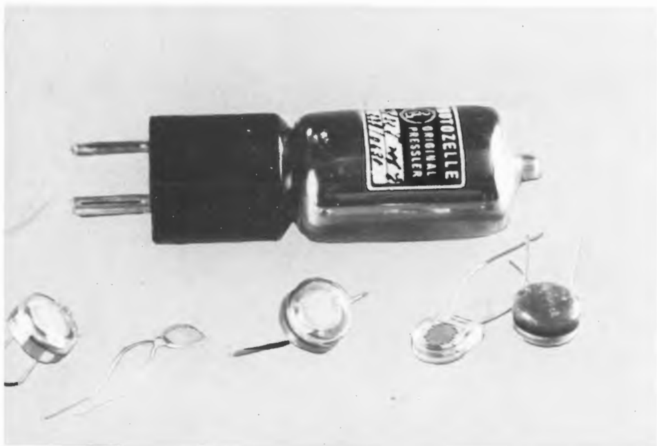
Foto 2. Una fotocellula confrontata con dei fotoresistori
