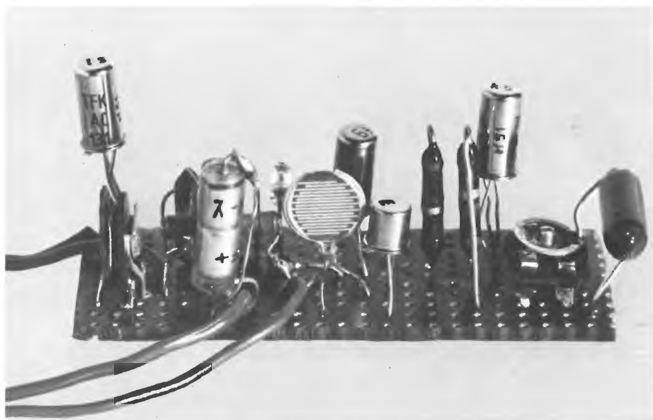
Foto 3. Vista del circuito della barriera luminosa
