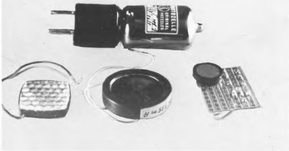
Foto 1. Una fotocellula (sopra) e tre fotoelementi (sotto)
