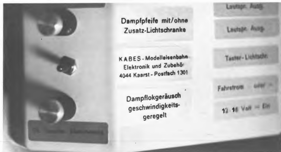
Fig. 7. Dispositivo per la generazione degli sbuffi della locomotiva e del fischio a vapore in un contenitore con comandi a pulsanti. L'interruttore mette in funzione uno dei due circuiti stampati a seconda della sua posizione. Nella posizione intermedia il dispositivo è disinserito.
