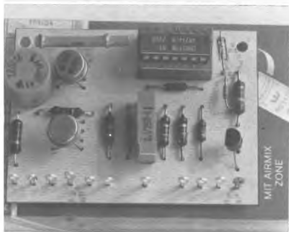
Foto 11. L'interruttore acustico montato.
