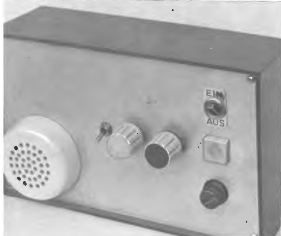
Foto 12. Vista frontale dell'interruttore acustico, montato in una custodia TEK0.
