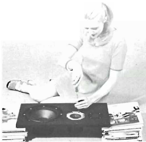
Fig. 3 - Il pannello frontale va verniciato di nero. Gli altoparlanti devono essere fissati in maniera che i loro terminali di collegamento si trovino davanti a quelli del filtro in modo da evitare lunghi percorsi
