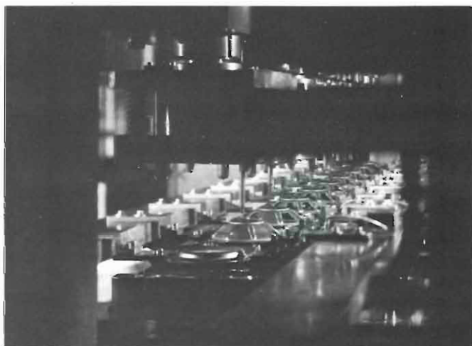
Fig. 9 - Fase di costruzione dei cestelli degli altoparlanti.
