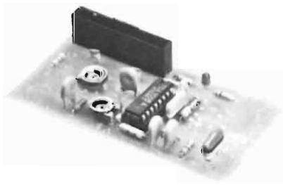
Fig. 1 - Prototipo di decodificatore t.d.s. (time division multiplex) comprendente tutti i componenti periferici che figurano nello schema di fig. 2
