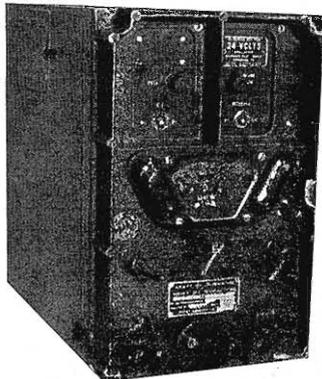
BC652 - Frequenza da 2 a 3,5 Mc da 3,5 a 6 Mc. Modulazione Amp.. Completo di valvole, alimentazione 12 V.
