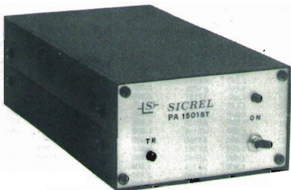
ALIMENTATORE STABILIZZATO con altoparlante ellittico incorporato
