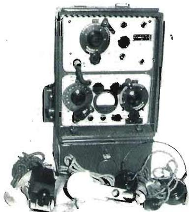
**Stazione radio ricetrasmittente Wireless set - tipo 48 MK I.** Portatile. Produzione canadese. Peso kg 10. Dimensioni forma rettangolare cm 45 x 28 x 16 + supporto di antenna orientabile. Funzionante a batterie a secco. Frequenza variabile da 6 a 9 Mc, 40-45 m. Calibrata a cristallo con cristallo 1000 Kc. Impiega 10 valvole di cui: 3/1LD5 2/1LN5 2/1LA6 2/1A5 2/1299-3D6. Viene corredata di: antenna - cuffia - microfono - tasto - manuale tecnico.
