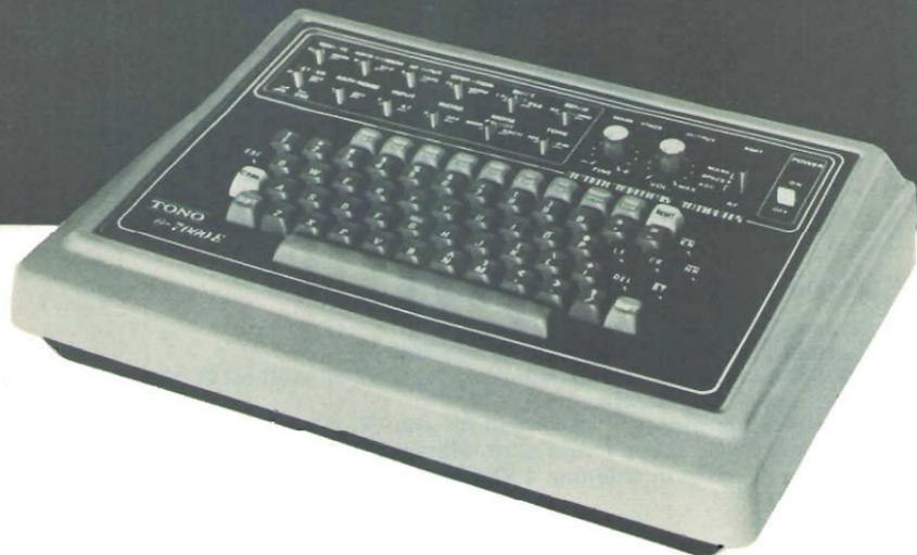
Il nuovo tetha grazie all'utilizzo di un microcomputer permette la ricezione e trasmissione automatica in CW, RTTY ed ASCII e la diretta lettura su un comune televisore domestico o monitor di segnali in arrivo o in trasmissione. L'apparato è completo di modulatore demodulatore a filtri attivi dalle ottime prestazioni.
