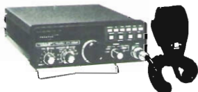
FT 480 R: ricetrasmittitore per i due metri in SSB CW-FM da 143,500 a 146,500 Mhz - 30 W PEP - doppio VFO - 4 memorie - speciale per satelliti.
