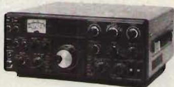
Ricetrasmittitore HF digitale, AM - SSB - CW
