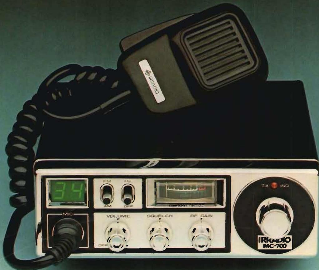
Lo MC-700 è un ricetrasmittitore mobile realizzato con la tecnologia PLL. Offre i 34 canali (23+11) autorizzati nella banda CB dei 27 MHz. Opera nei modi AM e FM. Potenza 1,5 W. È completo di RF gain e di filtro ANL. Lo MC-700 è omologato dal ministero delle PP.TT. Numero omologazione DCSR/2/4/144/06/79537.
