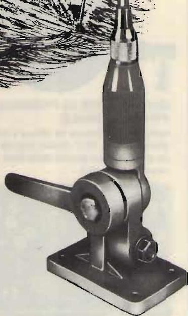
**Frequenza 26 + 30 MHz; Impedenza 50  $\Omega$ ; Potenza massima 50 W; R.O.S. 1 - 1:1; Numero canali 40; Altezza massima 160 cm.; Peso 400 gr.; Cava RG 58 A/U m. 4; Materiale della base nylon; Materiale dello stilo fiberglass.**
