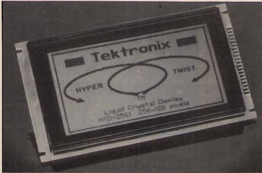
figura 2 "I display a cristalli liquidi super-ruotati rappresentano un importante progresso nella produzione di visori LCD facilmente leggibili".
