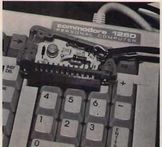
foto 1 Circuito stampato, lato componenti.
