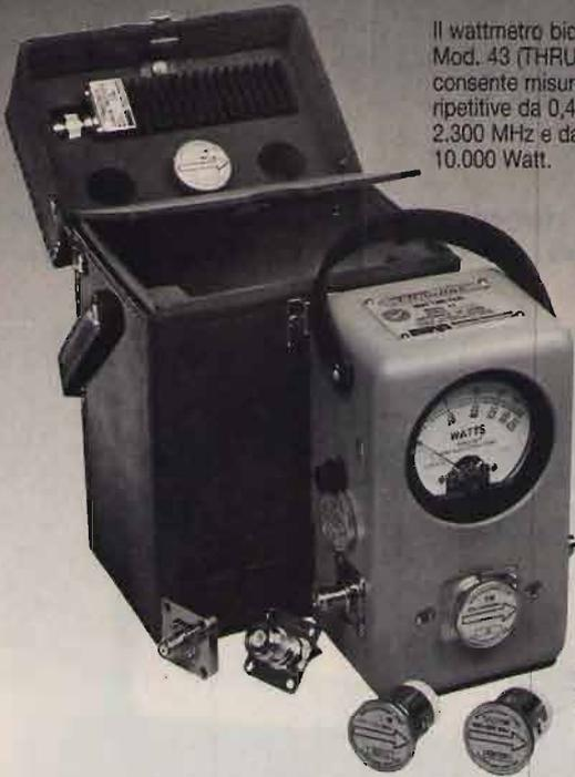
Il wattmetro bidirezionale Mod. 43 (THRULINE) consente misure precise e ripetitive da 0,45 a 2.300 MHz e da 0,1 a 10.000 Watt.
