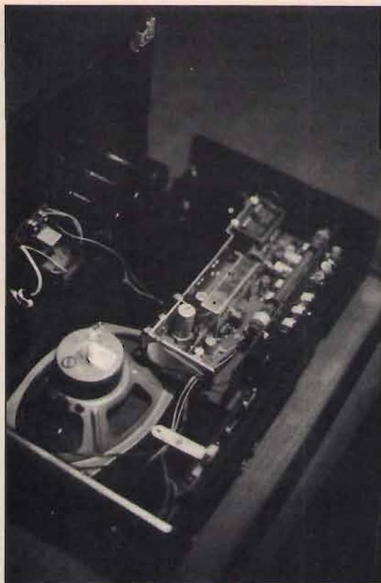
L'interno del ricevitore commerciale con l'antenna-ferrite sul cui campo interviene l'antenna a quadro del Deutschlandfunk. Il Magic Disc non necessita collegamenti diretti: è sufficiente metterla a contatto con il ricevitore, possibilmente sul lato ferrite, in mancanza della quale non ha effetto.
