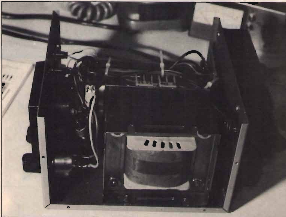
foto 3 Altra vista interna dell'alimentatore: è visibile il potenziometro a filo per la regolazione della corrente.
