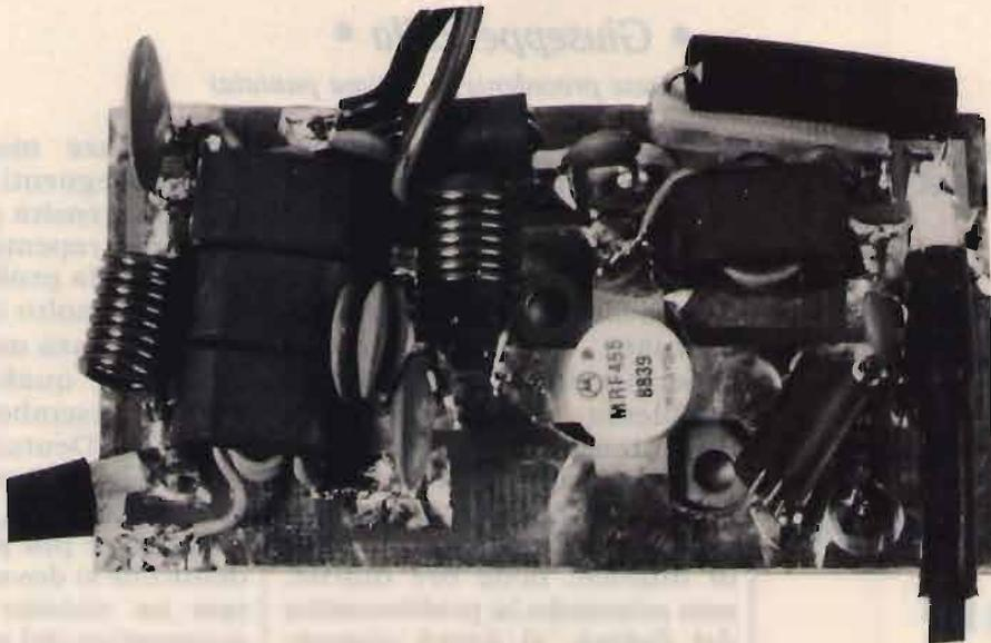
Questa scheda può essere inserita in qualsiasi tipo di ricetrasmittitore CB, consentendo di aumentare la potenza in uscita da 3 W ÷ 20 W e di conseguenza il livello di modulazione. Se misuriamo la potenza con un wattmetro e un carico fittizio mentre moduliamo, notiamo che questa passa da 20 W ÷ 40 W. Tutto questo sta a dimostrare il notevole rendimento di questa schedina sia in potenza che in modulazione.
