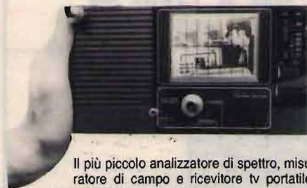
Il più piccolo analizzatore di spettro, misuratore di campo e ricevitore tv portatile.
