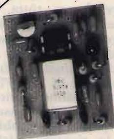
**FE290 - SCRAMBLER MINIATURA AD INVERSIONE DI BANDA.** È il più piccolo scrambler disponibile in commercio. Le ridotte dimensioni ne consentono un agevole inserimento all'interno di un qualsiasi RTX. Il circuito rende assolutamente incomprensibile la vostra modulazione impedendo a chiunque capti la trasmissione di ascoltare le vostre comunicazioni. L'apparecchio è compatibile con gli scrambler utilizzati nei radiotelefoni SIP. FE290K (scrambler kit) Lire 45.000 FE290M (montato) Lire 52.000
