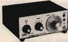
Minicircuito di transverter per i 40 metri (altre frequenze a richiesta). Minime dimensioni del c. stampato: mm 75x57 per una facile installazione in tutti i ricetrans. Commutazione R/T senza relè (elettronica). Se installato in apparati muniti di frequenzimetro (Uranus, Lincoln, Galaxy ecc.), il display indica la frequenza di lavoro in 40 mt. Provvisto di display e istruzioni. Non altera la modulazione.
