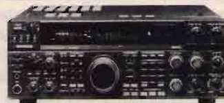
TS950SD - Ricetrasmittitore HF 100 kHz, 30 MHz (RX) - Modi SSB-CW-AM-FM-FSK - Potenza 150 W output - Processore digitale del segnale (DSP) - Doppio ascolto e lettura - Filtri inseribili indipendentemente dal modo di ricezione - Accordatore automatico controllato dal microprocessore.
