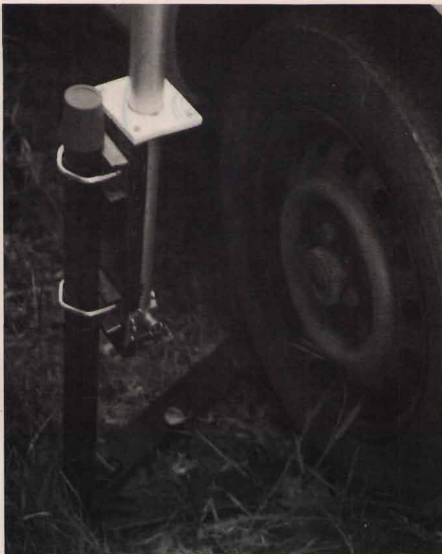
Particolare del basamento e dell'ancoraggio "a ruota"!
