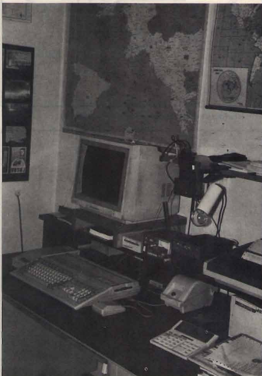
Amiga 500 + HD 52 Mb, TNC-2, FT 23-R, stazione packet VHF.
