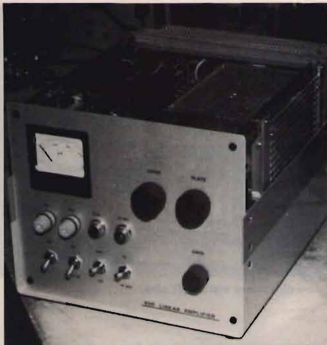
Vista frontale con il coperchio superiore asportato. Notare a destra la gabbia a RF.
