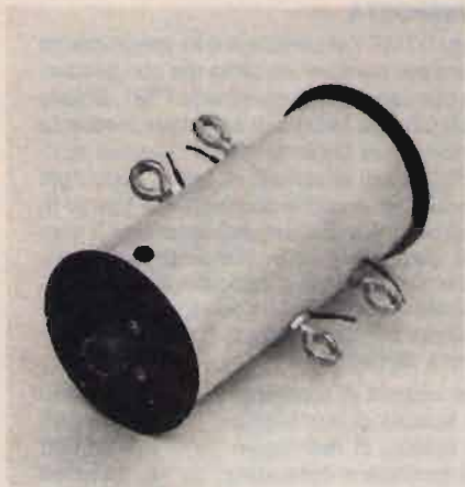
③ Il balun parallelo pronto all'uso come isolatore centrale e trasformatore di impedenza per dipolo multiplo per 20 e 12 metri (65 Ω bilanciati per i 20 metri, 100 Ω bilanciati per i 12 metri).
