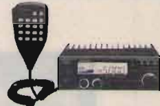
FT 2400 H Ricetrasmittitore FM/VHF veicolare - 50 W - 140-174 MHz.
