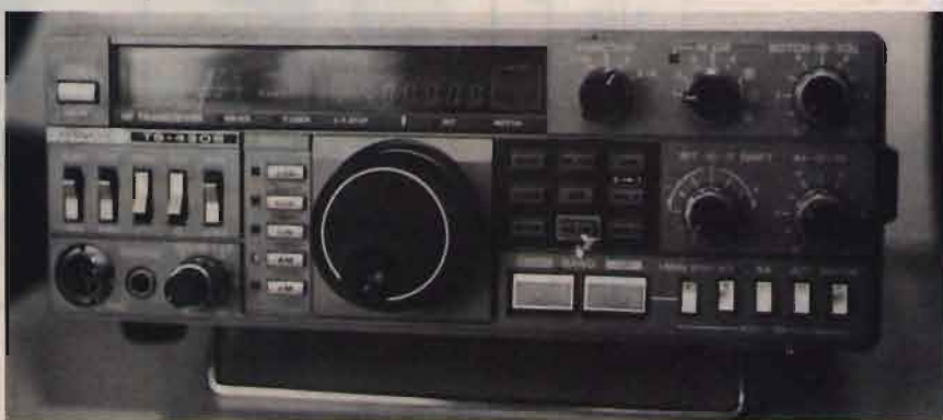
① Il TS-430 S: il primo ricetrasmittitore a sintonia continua costruito dalla Kenwood.
