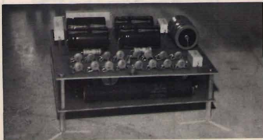
Le basette dell'alimentatore unite a "sandwich"; in basso la resistenza da 50 ohm/50 W.
