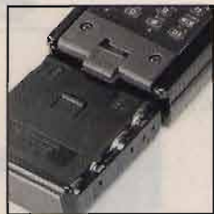
IL PACCO BATTERIE HA L'INNESTO A SLITTA
