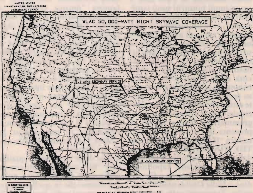
① Caratteristica dei lobi di radiazione prodotti dalle tre torri trasmettenti costituenti l'antenna direzionale di WLAC, 1510 kHz, e copertura notturna dell'onda ionosferica. Si notano i due punti di "null" o attenuazione del segnale in direzione nord est (verso Boston, WSSH) e direzione ovest (Spokane - KGA), a protezione di queste due emittenti operanti nella stessa frequenza di 1510 kHz.
