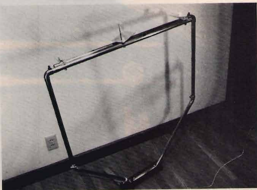
① Il loop per i 10-20 metri. Il condensatore di sintonia è formato dai due tubi del lato superiore, opportunamente spaziati.
