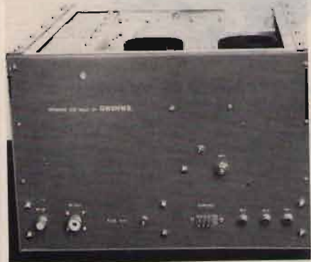
13 Il pannello posteriore dell'alimentatore ad alta tensione.
