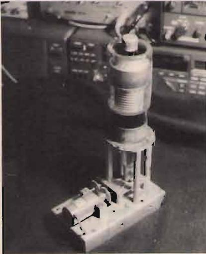
② "Assemblaggio di connessione del servomotore al Jennings (condensatore variabile sotto vuoto) di plate".
