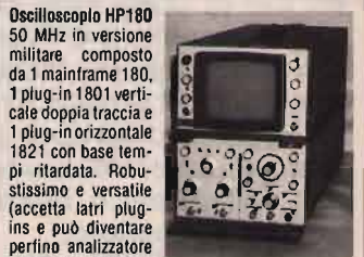
Oscilloscopio HP180 50 MHz in versione militare composto da 1 mainframe 180, 1 plug-in 1801 verticale doppia traccia e 1 plug-in orizzontale 1821 con base tempi ritardata. Robustissimo e versatile (accetta latr plug-ins e può diventare perfino analizzatore di spettro). Completo di sonda originale HP, manuali e contenitore metallico. Come nuovo L. 630.000 trasporto escluso.
