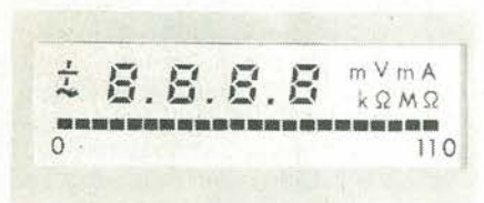
Fotografia 2. Una combinazione di valori analogici e digitali misurati usando gli LCD.
