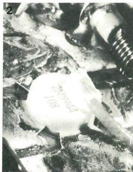
Foto 2 - Il diodo ed il transistor sono termicamente accoppiati tramite uno strato di pasta termoconduttrice. Un metodo ancora migliore sarebbe di collegare il diodo al dissipatore termico nelle immediate vicinanze del transistor, ma questo è possibile in pratica solo con molte difficoltà.
