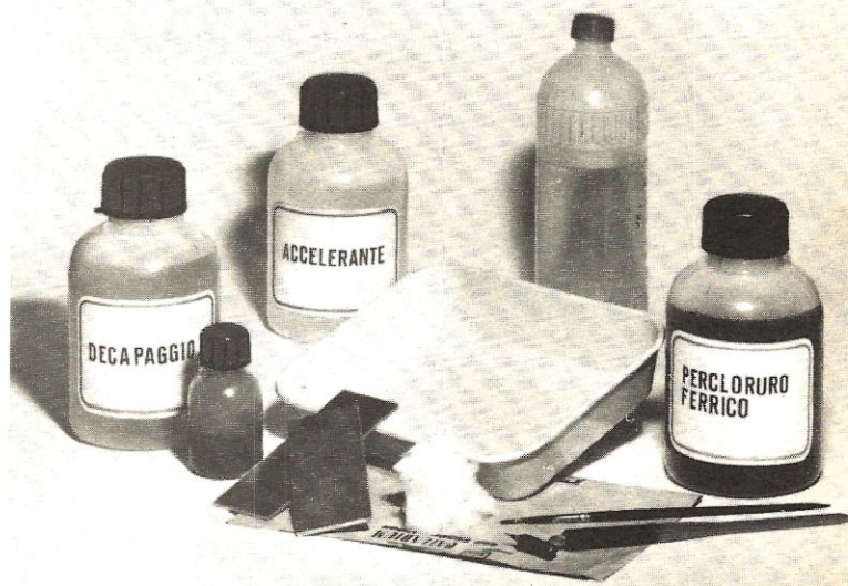
Fig. 12 - L'occorrente per preparare un qualsiasi circuito stampato si riduce praticamente a quanto presentato in questa fotografia, una bacinella in plastica, i due liquidi per l'incisione, quello di decapaggio, l'inchiostro protettivo, una bottiglia di alcool denaturato, della carta carbone, un pennello e pennino da normografo, e logicamente delle piastre di bachelite ramate.
