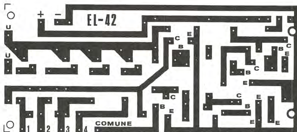
Fig. 2 Circuito stampato a grandezza naturale del frequenzimetro a lettura diretta. Questo circuito è reperibile già inciso su fibra di vetro.
