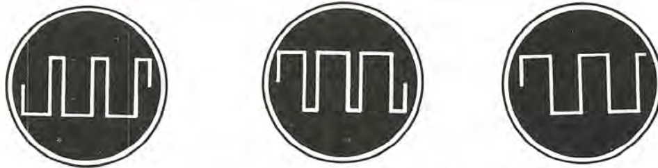
Fig. 8 Il trimmer R1 serve rendere perfettamente lineare la forma d'onda. Se avete un oscilloscopio potrete ruotare il cursore di R1 in modo da ottenere sullo schermo, la forma d'onda visibile a destra. I disegni di sinistra e al centro mostrano l'onda quadra quando R1 non è regolato nella sua giusta posizione. Se non possedete un oscillografo, procedete come spieghiamo in articolo.
