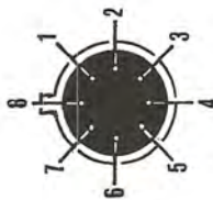
Fig. 7 Disposizione dei terminali dell'UA.709. In questa figura sono visibili dal lato in cui fuoriescono dallo zoccolo.
