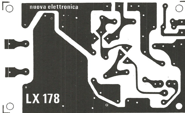
Fig. 3 Circuito stampato a grandezza naturale dell'alimentatore.
