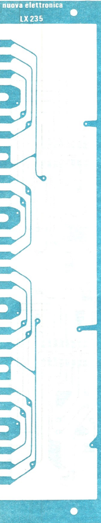
Fig. 2 Circuito stampato necessario per la realizzazione di questa scala parlante luminosa. Questo circuito è a doppia faccia, quindi occorrerà collegare, dove è richiesto, le piste superiori con quelle inferiori.
