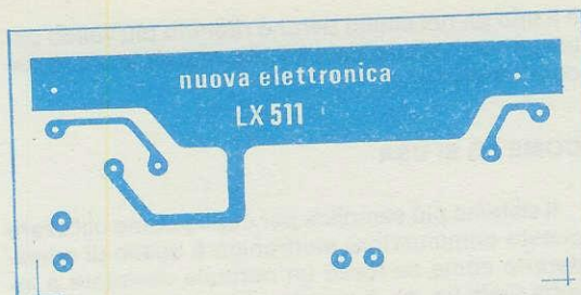
Fig. 6 Disegno a grandezza naturale del circuito stampato a doppia faccia necessario per questo Vu-Meter, e per altri equivalenti circuiti se si modifica il solo circuito d'ingresso.
