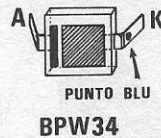
Fig. 2 Per individuare il Katodo del diodo dovrebbe essere presente su tale terminale un piccolissimo punto di vernice «blu». Nel caso che tale punto di riferimento risultasse inesistente si potrà sempre individuare il terminale Anodo poiché da tale lato all'interno del fotodiode è visibile una riga «nera».
