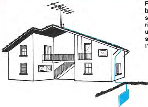
Fig.94 Sulla piastra che sotterrerete fissate in modo perfetto il filo di TERRA. Un palo messo a "terra" è in grado di disperdere tutte le eventuali scariche elettrostatiche che, diversamente, si scaricherebbero all'interno della TV mettendola fuori uso.
