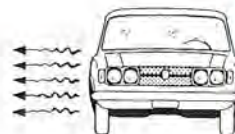
Fig.16 Se vi ponete su un marciapiede con il vostro rivelatore di raggi infrarossi rivolto verso la strada, tutte le auto e le moto che passeranno faranno deviare più o meno la lancetta dello strumento.
