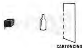
Fig.20 Per constatare se questo sistema risulta valido, fate passare di fronte al sensore una bottiglia piena di acqua calda e vedrete come questa venga subito rivelata.
