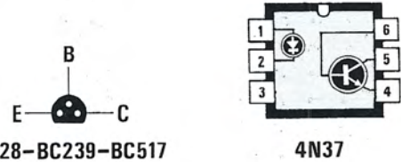
Fig.3 In alto, le connessioni dei semiconduttori utilizzati in tale progetto. Vi ricordiamo che tutti gli integrati sono visti da sopra, come dimostra anche la tacca di riferimento. I transistor sono invece visti da sotto, cioè dal lato in cui i terminali fuoriescono dal corpo. Per quanto riguarda il diodo led, abbiamo messo in evidenza la diversa lunghezza dei due terminali A - K.
