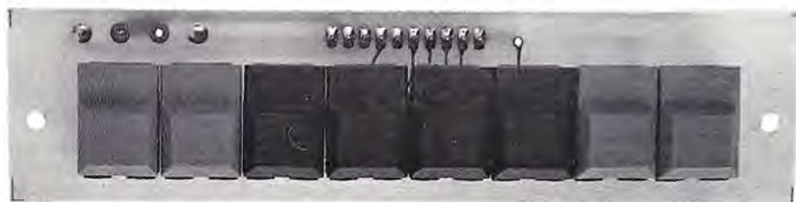
Fig.34 Schema elettrico relativo alla tastiera delle funzioni. I due deviatori Up-Down e Start-Stop come vedesi in fig.1 risultano fissati sul pannello frontale. Qui sotto, la foto della tastiera che, con i suoi otto tasti, vi consentirà di svolgere tutte le funzioni necessarie al funzionamento di questo Video-Converter.
