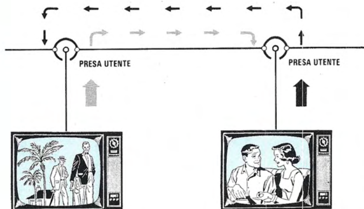
Fig.143 Le prese induttive con la loro elevata "attenuazione inversa" impediscono a questi segnali di disturbo di passare attraverso la linea da un televisore all'altro.
