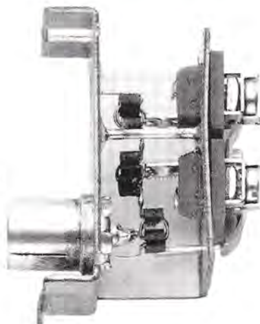
Fig.135 In questa foto, l'interno di una Presa Passante tipo PP.4,2. Poichè questa presa dispone di una attenuazione di passaggio di 4,2 dB, la sua uscita passante si potrà collegare direttamente ad una presa finale tipo PF.0.
