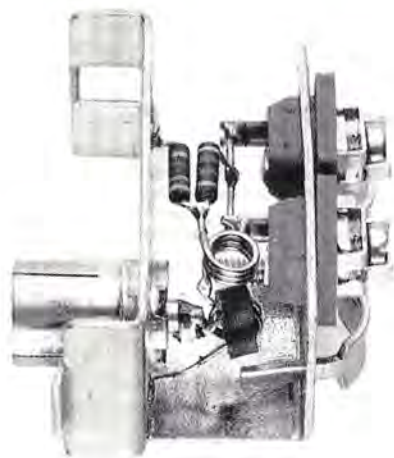
Fig.134 In questa foto vi facciamo vedere l'interno di una Presa Passante. Oltre ai nuclei in ferrite, è pure presente un partitore resistivo necessario per ricavare i diversi valori di attenuazione di uscita, cioè 14-20-26 dB.
