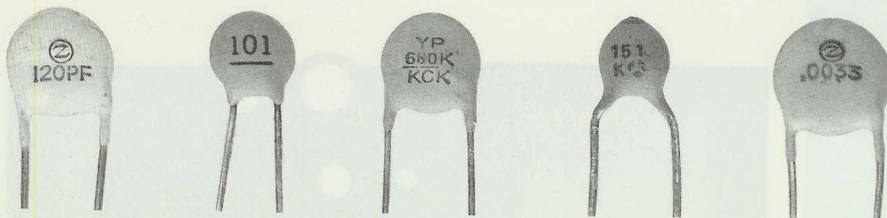
Fig.1 Decifrare il primo condensatore ceramico non sarà difficoltoso, poiché tutti leggeranno 120 pF, mentre per il secondo siglato 101 la capacità è di 100 pF. Il terzo siglato 680K è da 680 pF perché K significa Keramico (ceramico). Il quarto siglato 151 è da 150 pF, mentre per quello di destra siglato 2A273K non si dovrà leggere nè 2A nè K, quindi rimane 27 + 000, cioè 27.000 pF.
