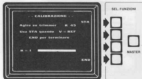
Fig.25 Sullo schermo rimarranno le scritte presenti nella fig.24, ma al posto di V = 59 apparirà B = I (banda 1°) e automaticamente partirà una barra che memorizzerà nella RAM la linearità del Tuner.
