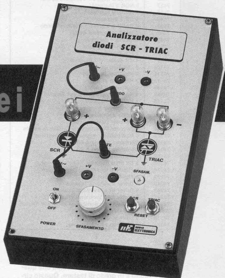
Fig.1 Questo analizzatore vi permetterà di verificare il comportamento di un diodo SCR o TRIAC alimentando il suo Anodo con una tensione continua o alternata ed eccitando il suo Gate con tensioni CC, AC e sfasate. I due spinotti presenti sul pannello ci permetteranno di scegliere le tensioni da applicare all'Anodo ed al Gate.
