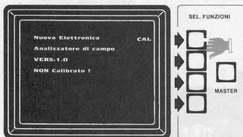
Fig.22 La prima volta che accenderemo l'Analizzatore dovremo pigiare il tasto CAL ( calibrazione ) e così sullo schermo del monitor apparirà la scritta che ci indica che il nostro Tuner NON è CALIBRATO.
