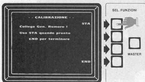
Fig.23 La scritta CAL si cambierà in STA ( start ) e automaticamente apparirà la scritta "Collega Gen. Rumore" ( vedi fig.21). Acceso il pulsante CALIBRAZ., dovremo pigiare il tasto STA.
