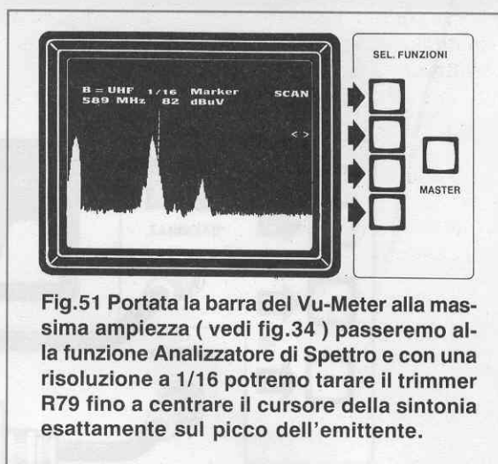
Fig.50 Per tarare il "trimmer R79" potremo utilizzare la funzione Analizzatore di Spettro. Sintonizzata un'emittente, portando la barra del Vu-Meter alla massima ampiezza potremo tarare il trimmer come spiegato nel capitolo TARATURA DEL TRIMMER R79.
