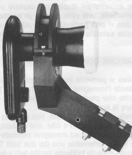
Fig.7 Il corpo del convertitore LNB viene fissato tramite un collare sull'estremità del braccio della parabola. Come cavo di discesa si può utilizzare del comune cavo TV-UHF saldando alle due estremità i connettori maschio tipo F.
