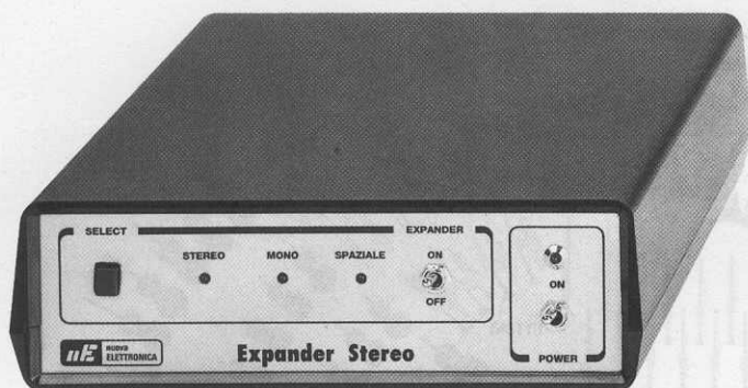
Fig.4 Il circuito viene racchiuso in un elegante mobile plastico di colore nero provvisto di un pannello forato e serigrafato.
