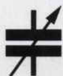
Fig.74 Simbolo grafico di un compensatore. La freccia posta sul simbolo indica che la sua capacità è variabile.
