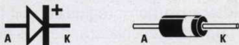
Fig.88 Negli schemi elettrici il "diodo" viene indicato con il simbolo visibile sulla sinistra. La fascia colorata posta sul corpo del diodo indica il terminale Catodo.
