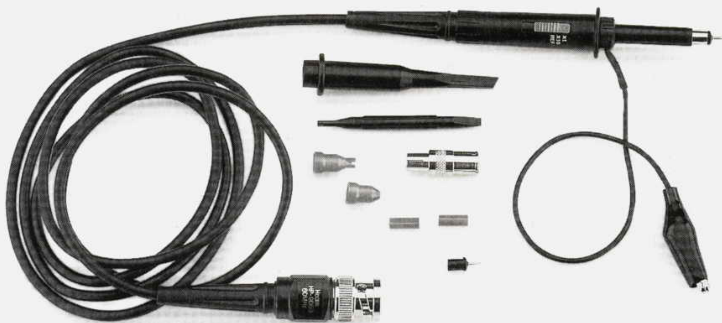
Fig.25 Come abbiamo spiegato negli articoli precedenti, sull'ingresso della sonda non dovrete mai applicare dei segnali che superano i 40 volt picco/picco (20 volt positivi e 20 negativi). Inserendo nell'ingresso il puntale sonda KM01.31 potrete arrivare ad un massimo di 400 volt picco/picco perché provvisto di due attenuatori X1 e X10. Questa sonda completa di tutti gli accessori visibili nella foto, può essere usata anche per oscilloscopi o altri strumenti di misura. Costo del puntale L.62.000 (abbonati L.55.800).
