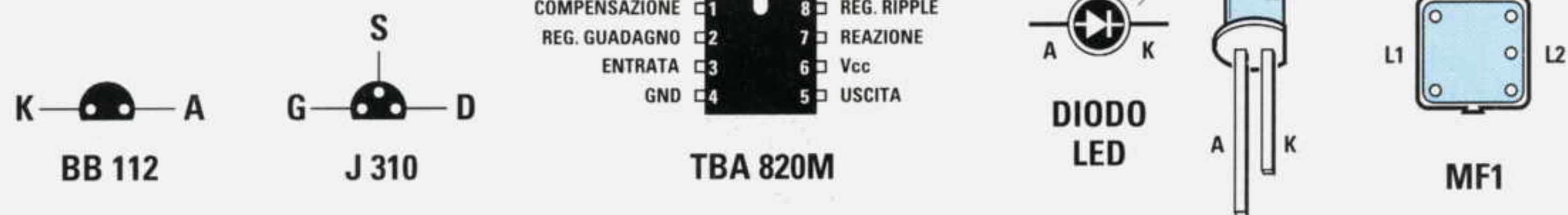
Fig.353 Connessioni dei terminali dei diodi varicap BB.112, del fet J.310 e della Media Frequenza MF1 viste da sotto. Le connessioni del solo integrato TBA.820/M sono viste da sopra. Ricordate che il terminale più lungo del diodo DL1 è l'A ed il più corto il K.
