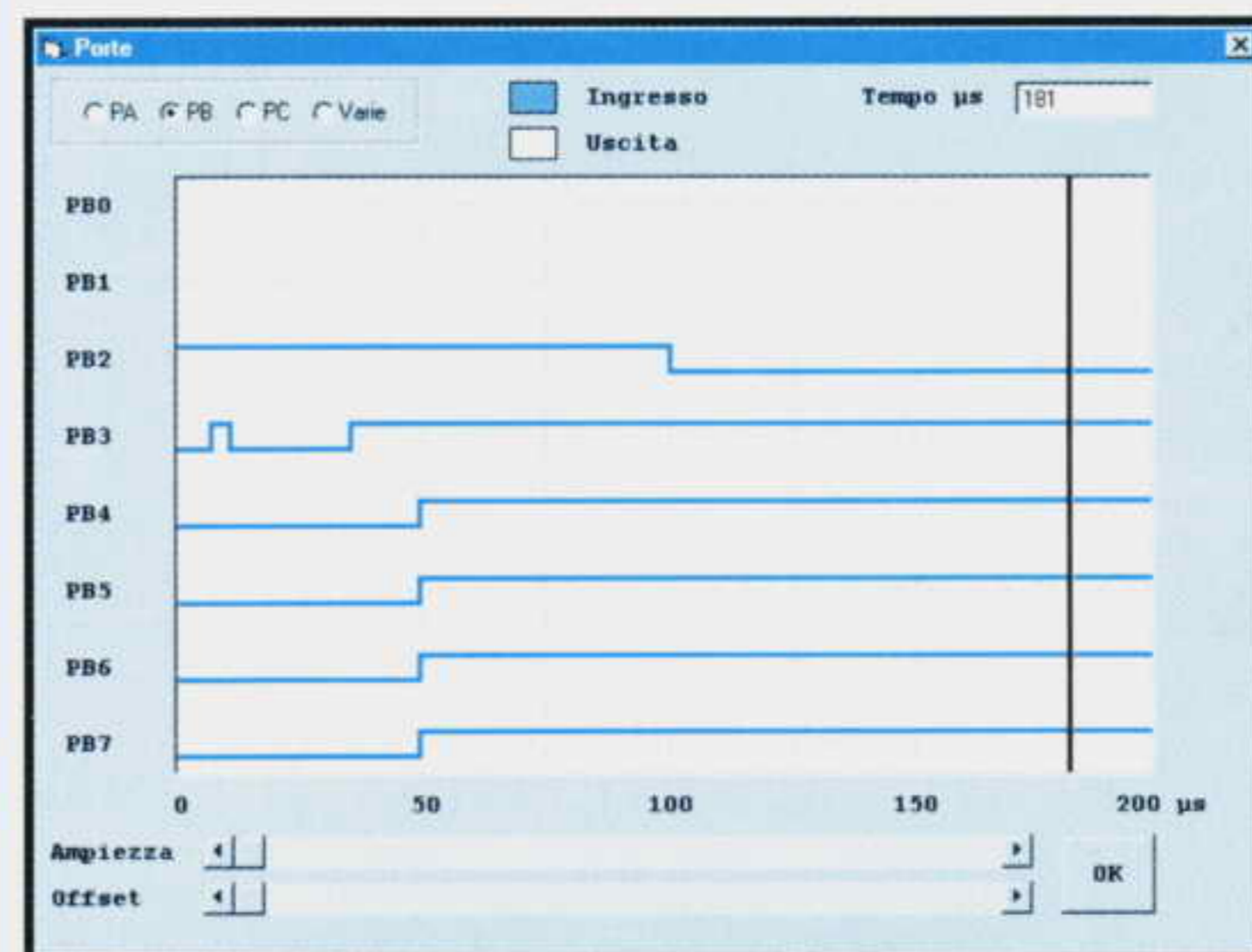
Fig.16 In questo grafico potete vedere tutti i livelli logici 1-0 che risulteranno presenti sulle porte configurate Out.
