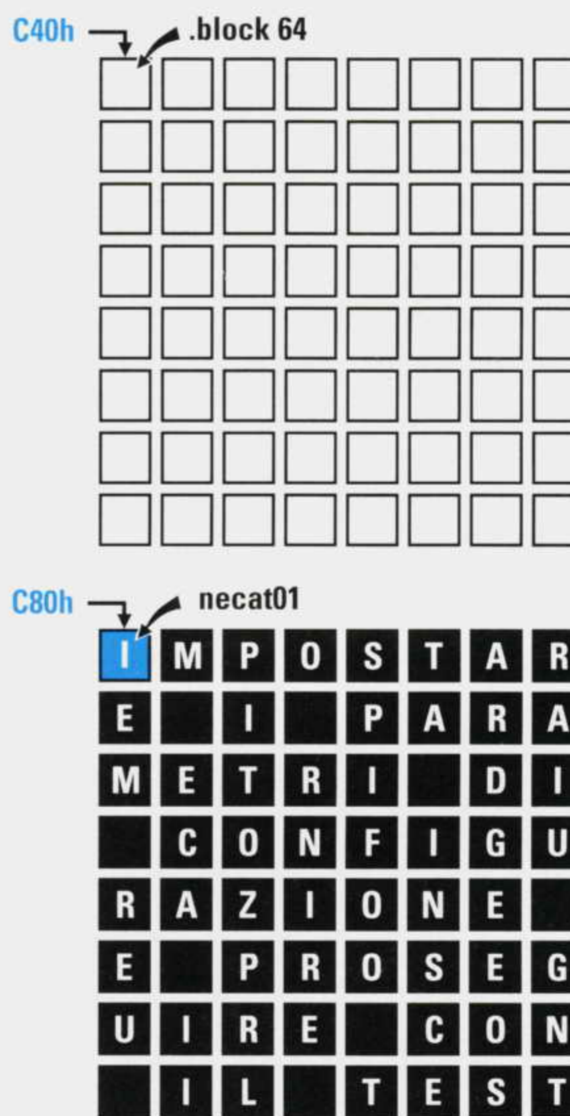
Fig.14 Infatti, inserendo .block 64-$%64 in una locazione di memoria divisibile per 64 senza resto, il testo viene posto nel blocco seguente sprecando l'area del primo.
