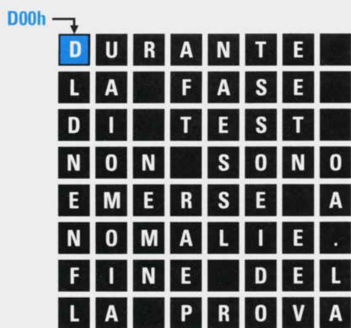
Fig.15 In questo esempio non è stata usata la direttiva .ifc ne ($%64) e per questo motivo il 1° e il 3° blocco sono vuoti.
