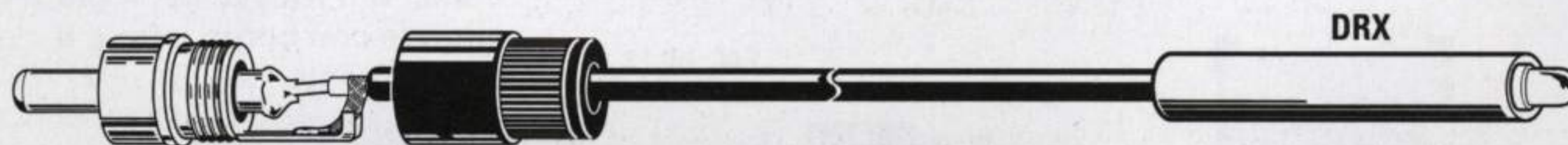
Fig.8 L'opposta estremità del cavetto coassiale andrà collegata allo spinotto maschio che troverete nel kit. La calza di schermo dovrà essere collegata sul terminale di massa dello spinotto. Conviene usare lo spinotto con il corpo di colore Nero per il diodo Ricevente e quello con il corpo di colore Rosso per il diodo Trasmittente.
