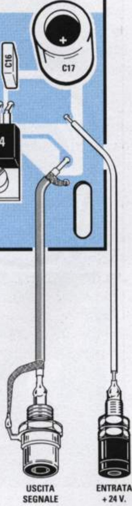
Fig.15 Schema pratico di montaggio della scheda LX.1358 ed in basso le connessioni degli integrati viste da sopra. La presa d'uscita del segnale BF e la boccia per entrare con i 24 volt di alimentazione andranno fissate sullo sportello laterale presente nel mobile verticale.
