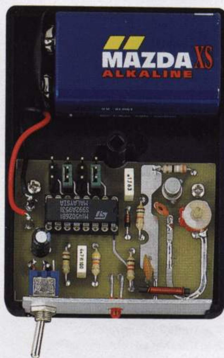
Fig.16 Il trasmettitore è racchiuso dentro un piccolo mobile plastico completo di un vano per contenere la pila da 9 volt.
