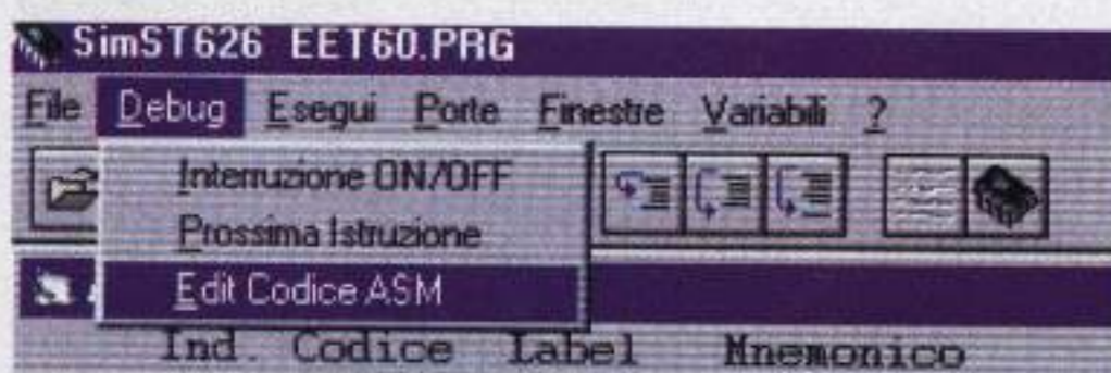
Fig.6 Con il comando Edit Codice ASM dal menu Debug si può modificare l'istruzione senza interrompere la simulazione.
