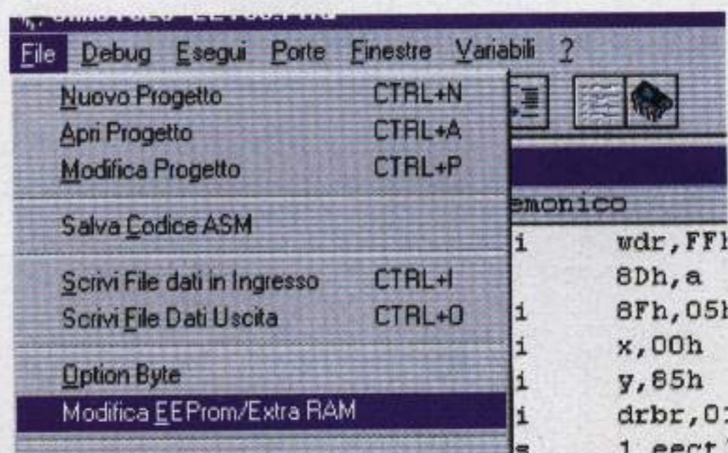
Fig.2 Per modificare la memoria Eeprom o la Ram aggiuntiva, scegliete dal menu File il comando Modifica EEPROM/Extra RAM.
