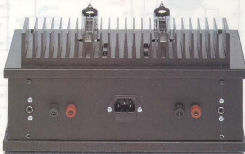
Fig.5 Foto del mobile visto da dietro. Si notino la presa di rete dei 230 volt, le due morsettiere per le Casse Acustiche e le due bocchette d'ingresso per il segnale stereo BF.
