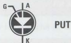
Fig.1 Il simbolo grafico che riportiamo qui sopra è quello di un PUT , cioè di un Programmable Unijunction Transistor . A differenza del diodo SCR (vedi fig.2) il suo terminale Gate esce in alto, in prossimità del terminale Anodo .
