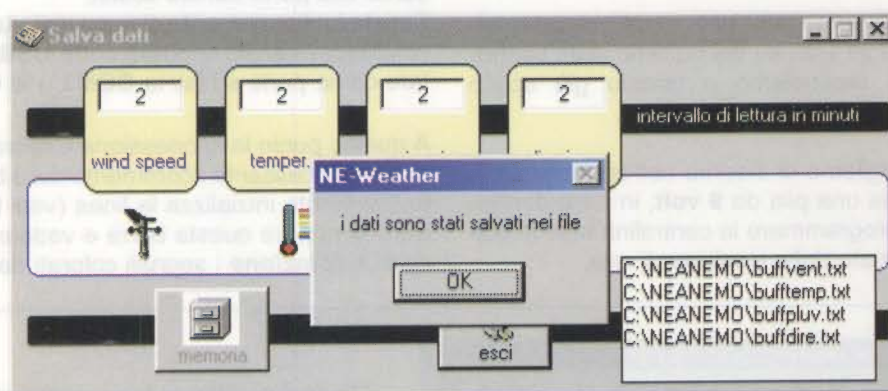
Fig.22 Quando ritenete di aver raccolto i dati per un periodo di tempo sufficiente, per rendere effettivo il loro salvataggio cliccate sul pulsante esci. Si aprono così due finestre: la prima è una finestra di conferma, mentre nell'altra potete leggere i nomi dei file generati in automatico dal computer. Per uscire cliccate su OK.
