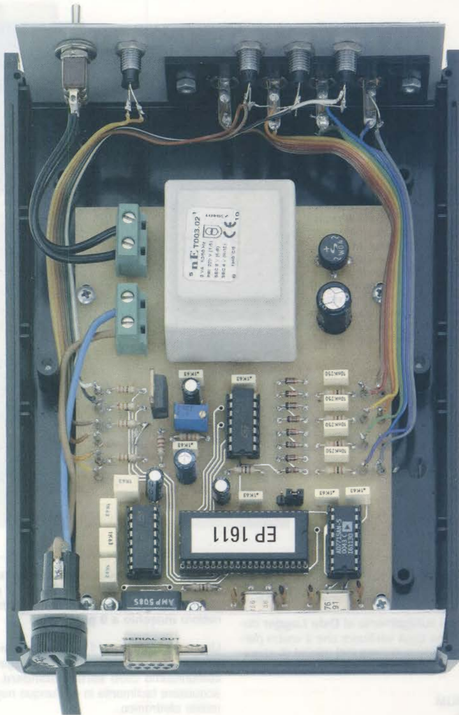
Fig.9 Nella foto è riprodotta la scheda LX.1611 montata all'interno del contenitore plastico. In basso a sinistra è visibile il connettore femmina a 9 poli utilizzato per la comunicazione con il computer, mentre in alto potete notare i collegamenti tra il circuito stampato base e i componenti posti sul pannello frontale del mobile.
