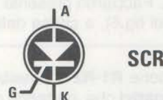
Fig.2 Il simbolo grafico di un SCR non può essere confuso con quello di un PUT perché il suo terminale Gate esce in basso, in prossimità del terminale Katodo . In fig.7 potete vedere come si presentano in pratica un PUT e un diodo SCR .
