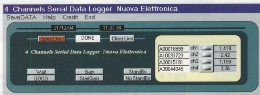
Fig.10 Cliccando sul tasto “Open Line” viene attivata la linea di trasmissione dati. Nelle 4 finestre di destra compariranno i valori di tensione in volt applicati ai 4 canali e a fianco i corrispondenti valori convertiti in digitale.
