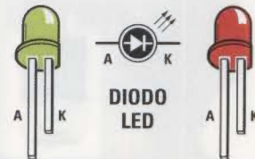
Fig.13 Connessioni degli integrati viste da "sopra" e dei transistor viste invece da "sotto". Per quanto riguarda i diodi led facciamo presente che il terminale più lungo è l'Anodo e il più corto è il Catodo (K). Guardando la fig.10 noterete che il terminale più "lungo" va rivolto verso destra.
