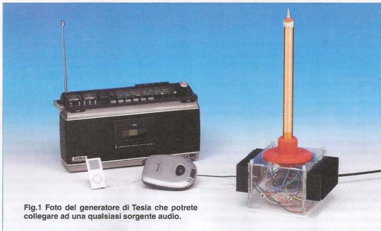
Fig.1 Foto del generatore di Tesla che potrete collegare ad una qualsiasi sorgente audio.
