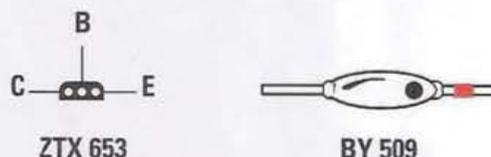
Fig.2 Connessioni del transistor ZTX653 viste da sotto e del diodo ad alta tensione BY509. Per individuare il terminale + di tale diodo vi rimandiamo alla fig.4.
