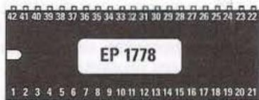
Fig.6 A sinistra le connessioni della Eprom EP1778 viste dall’alto e con la tacca di riferimento rivolta a sinistra.
