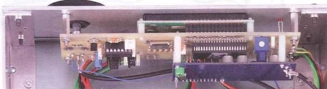
**Fig.27** Particolare della mascherina frontale nella quale va innestato il blocco formato dalla scheda CPU, pulsanti, display e dalla scheda in SMD KM1644.
