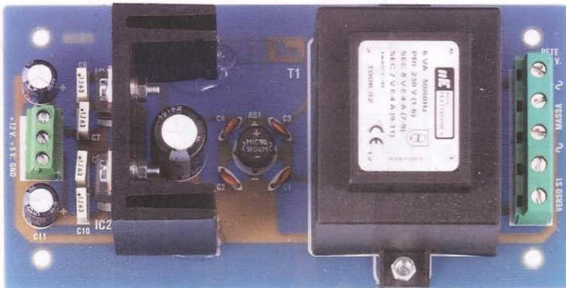
Fig.10 Sopra la foto dello stadio di alimentazione come si presenta a montaggio ultimato e sotto il disegno pratico dell'alimentatore. Si vedono anche i cablaggi all'interruttore S1 e alla vaschetta di rete e le alimentazioni per i due circuiti LX.1778 e LX.1778B.
