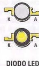
Fig.3 Connessioni dell'integrato 74HC14 viste dall'alto e con la tacca di riferimento rivolta verso sinistra, dei transistor BC547 e ZTX653 viste da sotto, e vista fronte e retro delle connessioni del diodo led da 1 Watt per SMD (codice =DL4.1). I terminali A e K sono caratterizzati da una diversa smussatura.
