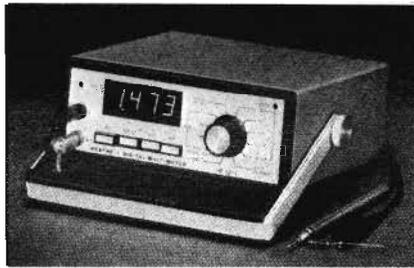
Figura 3 - Nella foto un tipo di multimetro digitale.
