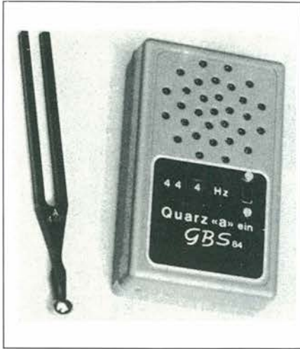
Figura 1. Il diapason elettronico fotografato accanto ad un vero diapason.
