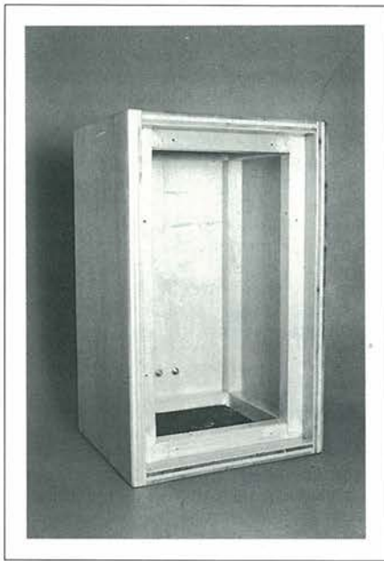
Fig. 7. La cassa assemblata. Si noti il blocchetto di gomma (120x100x4) incollato sul sotto. Uno analogo è incollato sul sopra.
