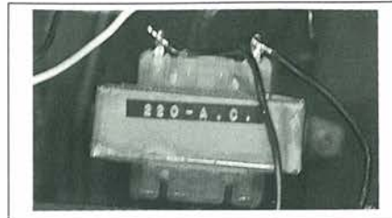
Foto 2. Il trasformatore elevatore è un normale elemento con secondario a bassa tensione.
