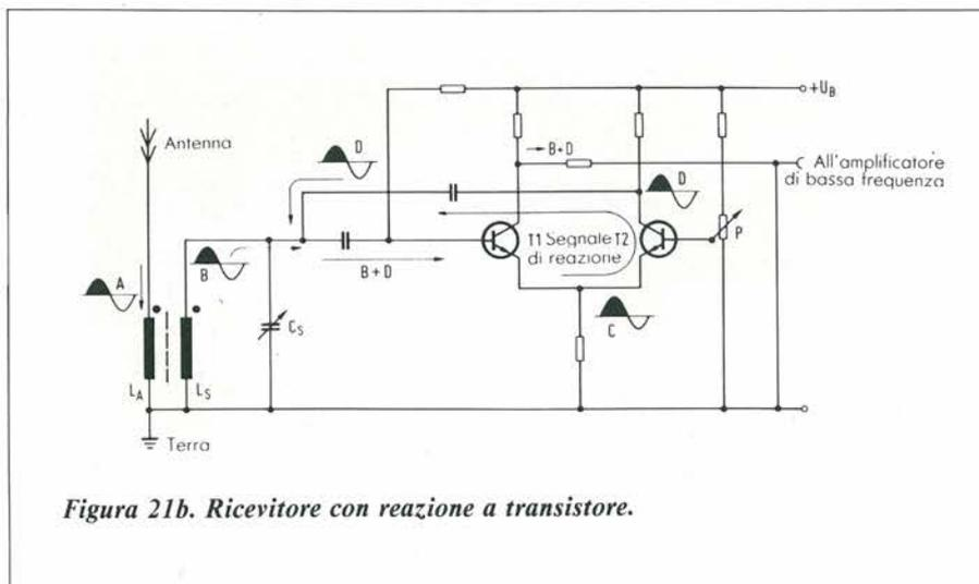
**Figura 21b.** Ricevitore con reazione a transistor.
