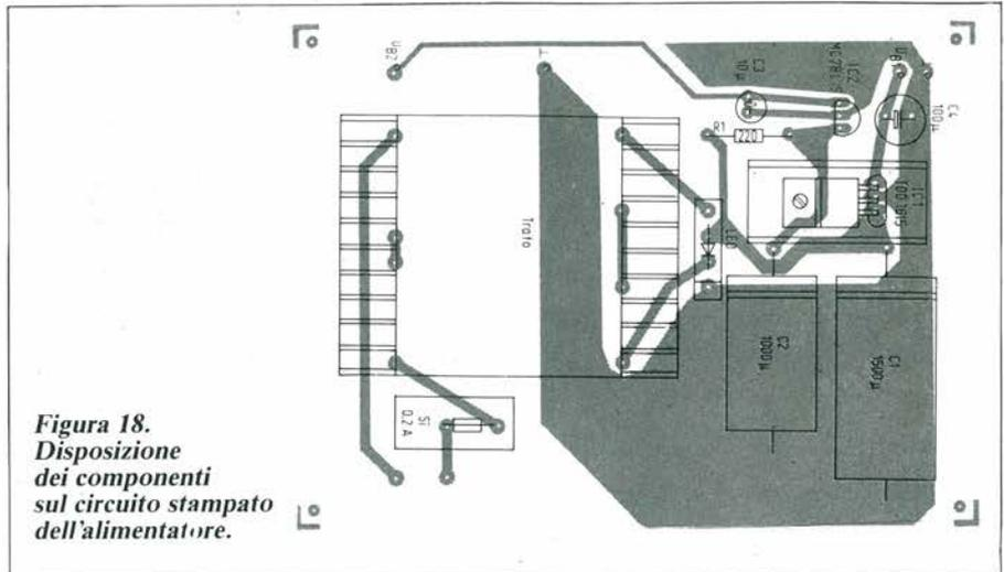
Figura 18. Disposizione dei componenti sul circuito stampato dell'alimentatore.
