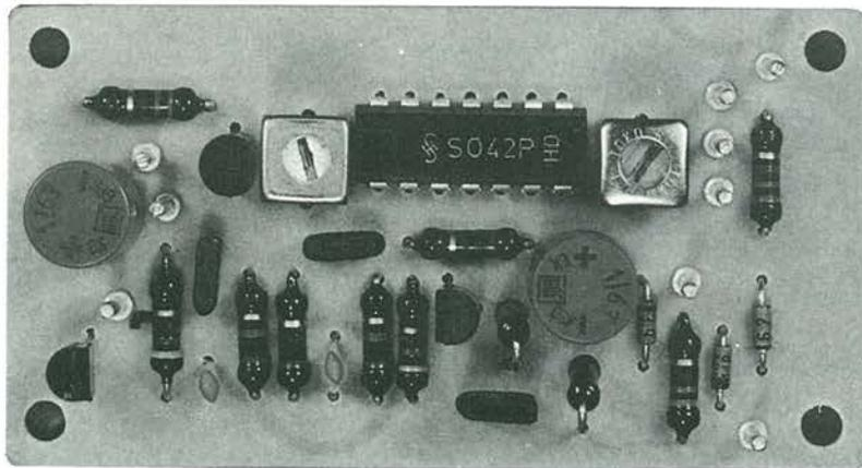
Foto 1. BFO per ricevitore ad onde corte.
