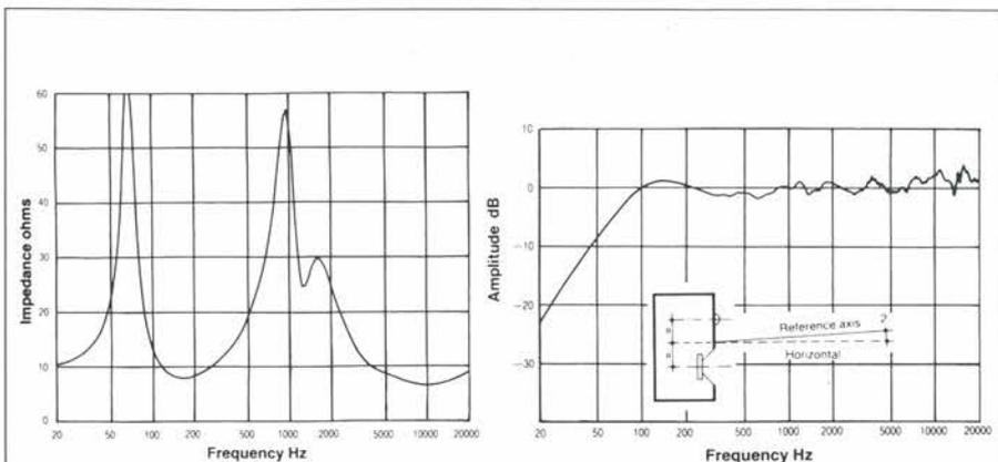
Figura 11. Il modulo dell'impedenza e la curva della risposta in frequenza della CS 1 A.
