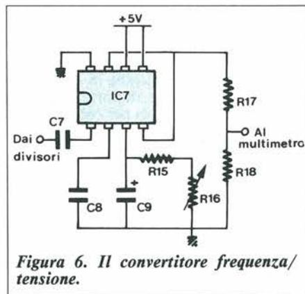
Figura 6. Il convertitore frequenza/tensione.
