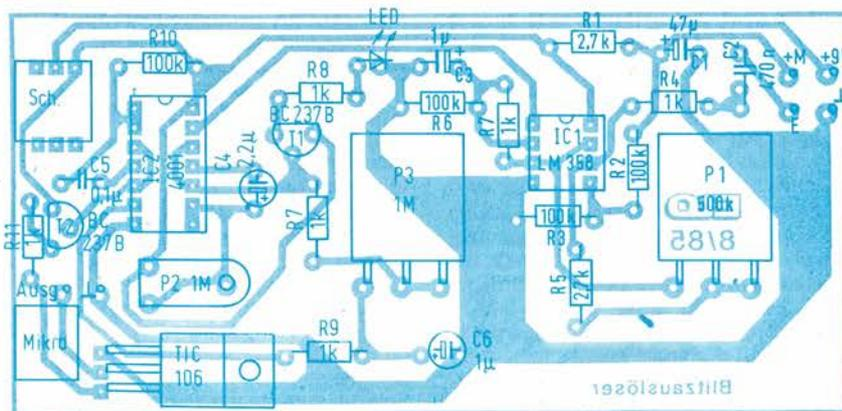
Figura 4: La disposizione dei componenti sul circuito stampato.
