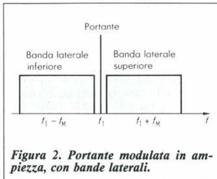
Figura 2. Portante modulata in ampiezza, con bande laterali.
