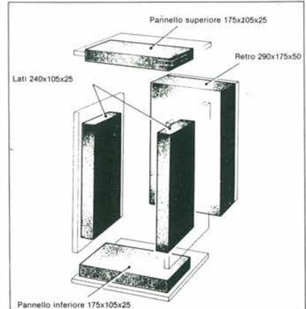
Figura 8. Schema del rivestimento fonoassorbente. Usare preferibilmente il poliuretano a cellule aperte con densità di 21 kg/m<sup>3</sup>. In alternativa usare la fibra di vetro.
