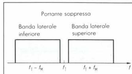
Figura 3. Modulazione a doppia banda laterale, con portante soppressa.
