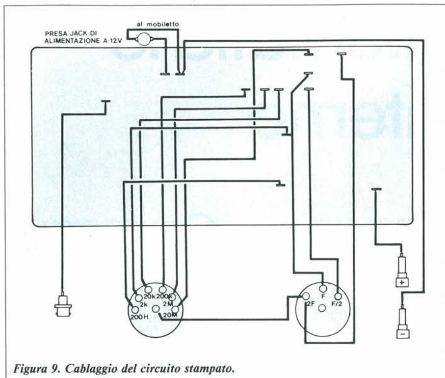
Figura 9. Cablaggio del circuito stampato.
