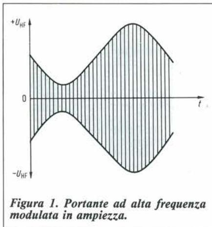
Figura 1. Portante ad alta frequenza modulata in ampiezza.
