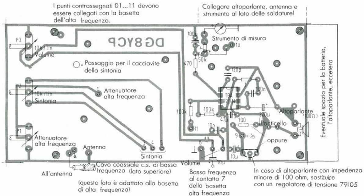
Figura 9. Disposizione dei componenti sulla basetta di bassa frequenza. Per poter raggiungere, dopo il montaggio, i punti di regolazione, nei punti contrassegnati dovranno essere praticati fori del diametro di circa 5 mm.
