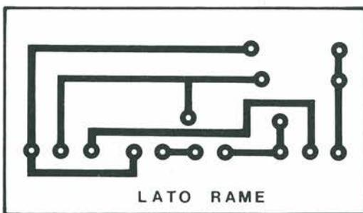
Figura 2: Il circuito stampato, visto al naturale sul lato rame. Si possono adottare senza difficoltà anche soluzioni di montaggio più semplici.
