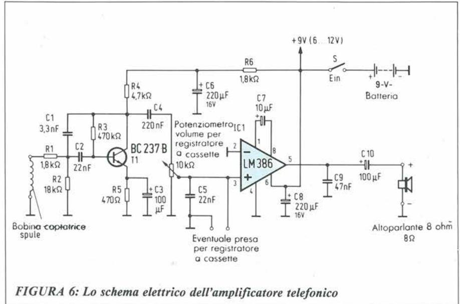
FIGURA 6: Lo schema elettrico dell'amplificatore telefonico
