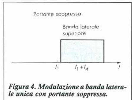
Figura 4. Modulazione a banda laterale unica con portante soppressa.
