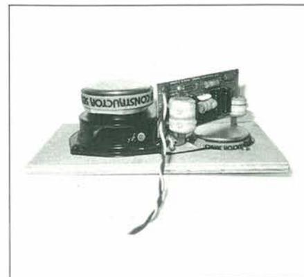
Figura 9. (A) Il pannello frontale della nostra CS 1 A visto dall'interno. La tavoletta raduna tutta la parte elettrica: altoparlanti e crossover. Per quest'ultimo abbiamo dovuto trovare una sistemazione un po' anomala, rispetto alla Rogers originale (B)
