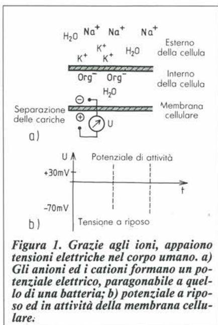
Figura 1. Grazie agli ioni, appaiono tensioni elettriche nel corpo umano. a) Gli anioni ed i cationi formano un potenziale elettrico, paragonabile a quello di una batteria; b) potenziale a riposo ed in attività della membrana cellulare.
