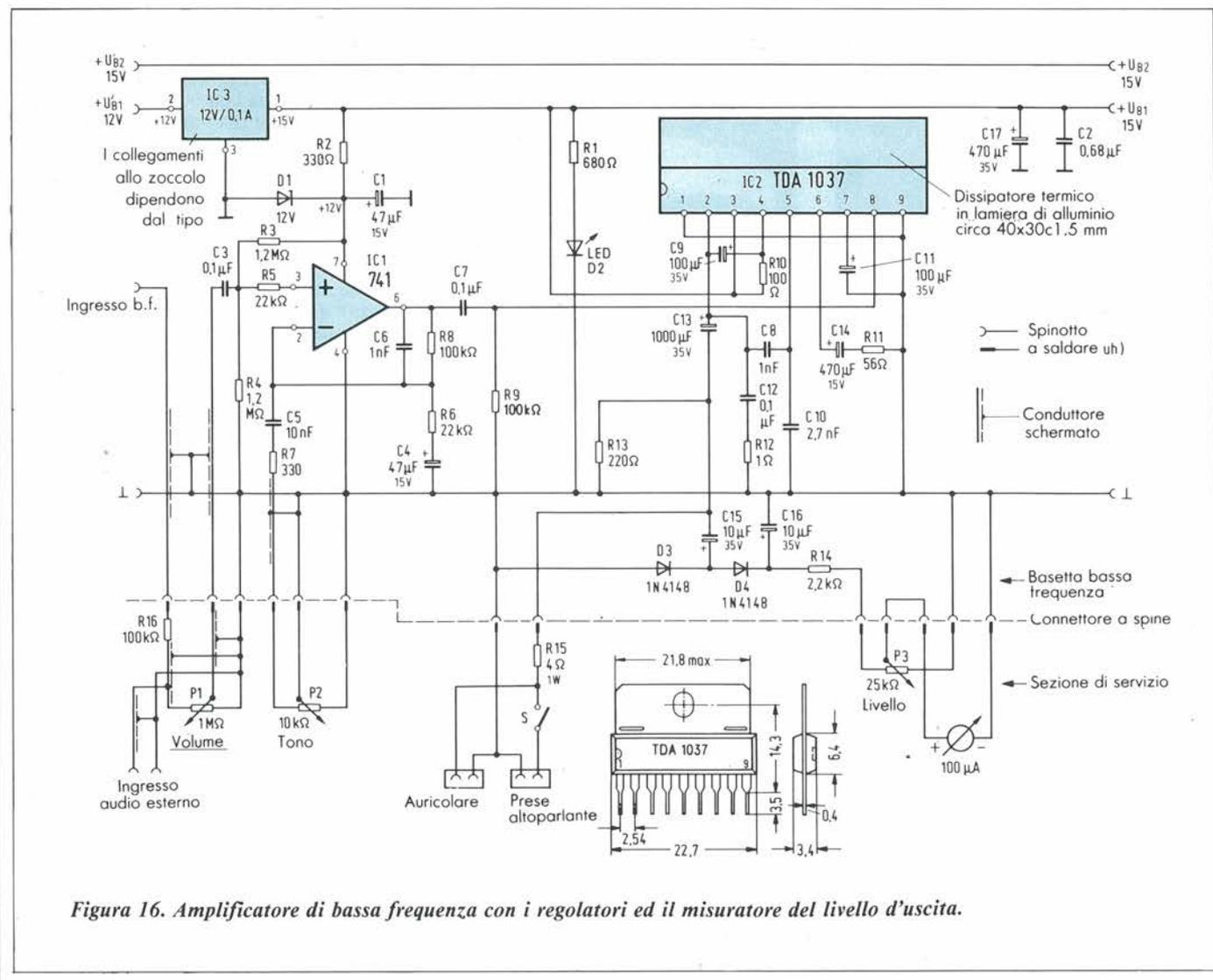
Figura 16. Amplificatore di bassa frequenza con i regolatori ed il misuratore del livello d'uscita.
