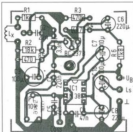
FIGURA 9: La disposizione dei componenti sul circuito stampato
