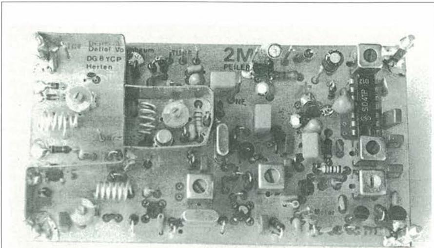
Figura 4. Basetta di alta frequenza completamente montata. I lamierini di schermo, visibili anche sul disegno della disposizione dei componenti, sono indispensabili.
