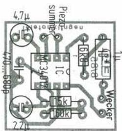
FIGURA 4: Disposizione dei componenti sul circuito stampato
