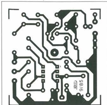
FIGURA 8: Il circuito stampato dell'amplificatore, al naturale
