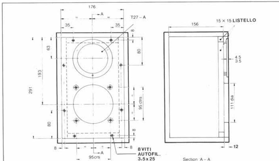
Figura 7. I due progetti KEF tra loro molto simili. A sinistra il CS 1 A, che si ispira alla Rogers LS3/5A e monta il woofers dall'interno; a destra la CS 1, che si ispira alla KEF modello 101 e monta il woofers dall'esterno.
