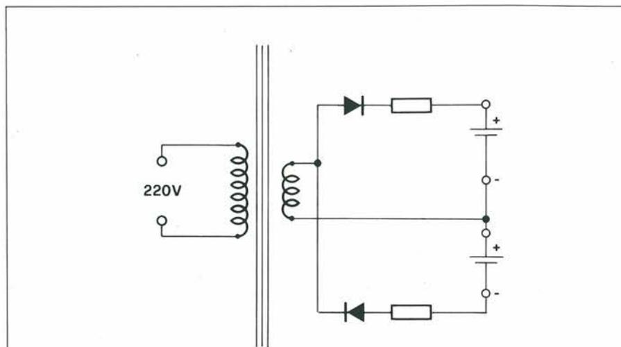
**Figura 1.** Schema di un semplice caricatore commerciale che consente la ricarica indipendente di due elementi al Nickel-Cadmio. Ogni elemento è alimentato separatamente da un rettificatore ad una semionda, tramite un resistore di caduta che regola (molto approssimativamente) la corrente di carica al valore prescritto.
