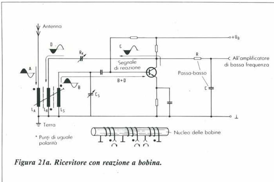
**Figura 21a.** Ricevitore con reazione a bobina.
