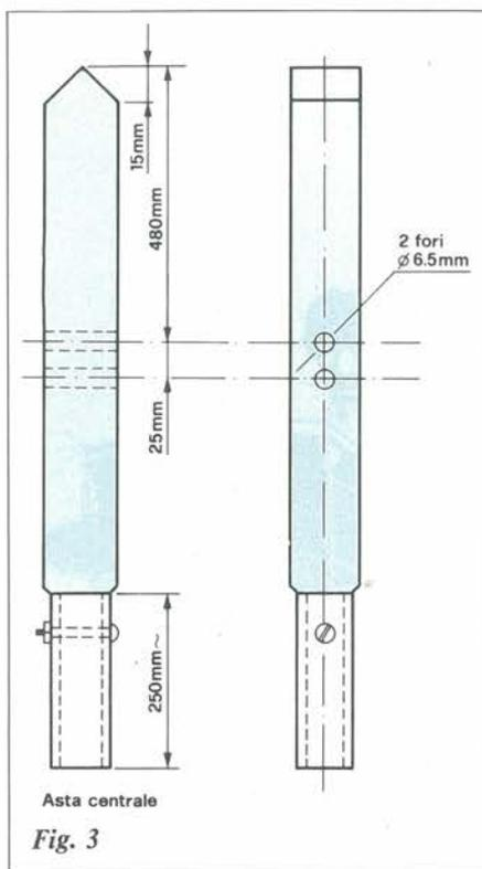
to essere una possibile risposta a questo problema: di installazione verticale, trova posto su qualsiasi tetto o balcone, e la sua sistemazione non crea più difficoltà di quella di un sistema di antenne per la ricezione delle TV locali. Essa dà risultati sorprendenti dando vari punti a tutte le filari fin dalle... profondità delle VLF
