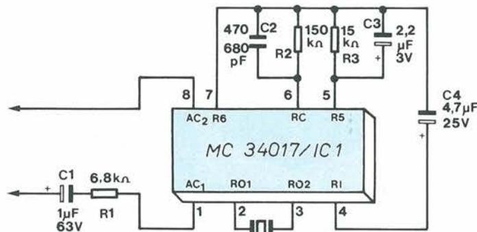
FIGURA 2: Lo schema elettrico della suoneria assemblata
