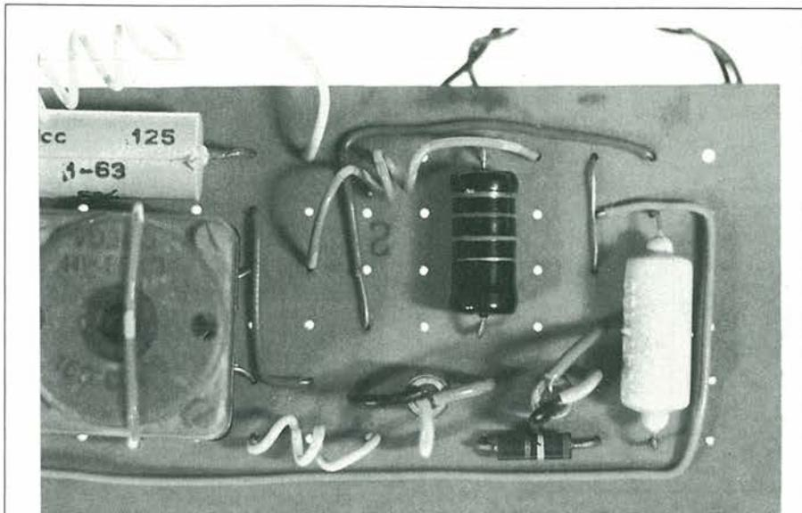
**Figura 2.** Cablaggio della sezione del generatore di nota. A destra, è visibile il condensatore C1 che determina la frequenza del segnale audio generato. Al centro i due transistor e, sopra, il resistore di disaccoppiamento R2. Si noti anche, a sinistra, il grosso induttore di carico dell'oscillatore L2: si tratta di un elemento del surplus che può essere sostituito con altri analoghi.
