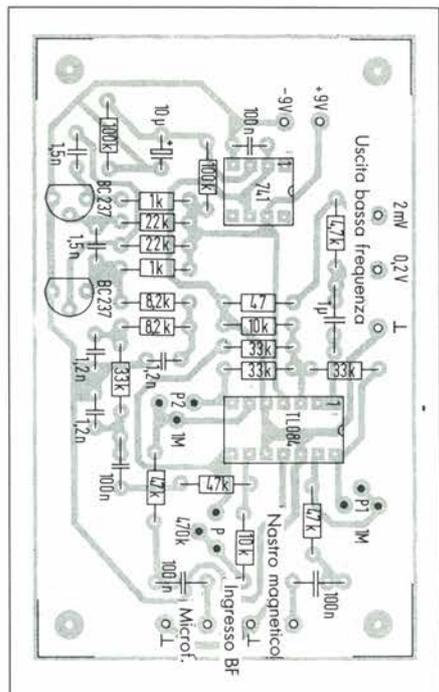
lità d'ingresso è previsto anche un partitore di tensione. Mediante trimmer collegati agli ingressi, il campo di regolazione dei canali potrà essere spostato in modo da poter intervenire su di essi con facilità.
