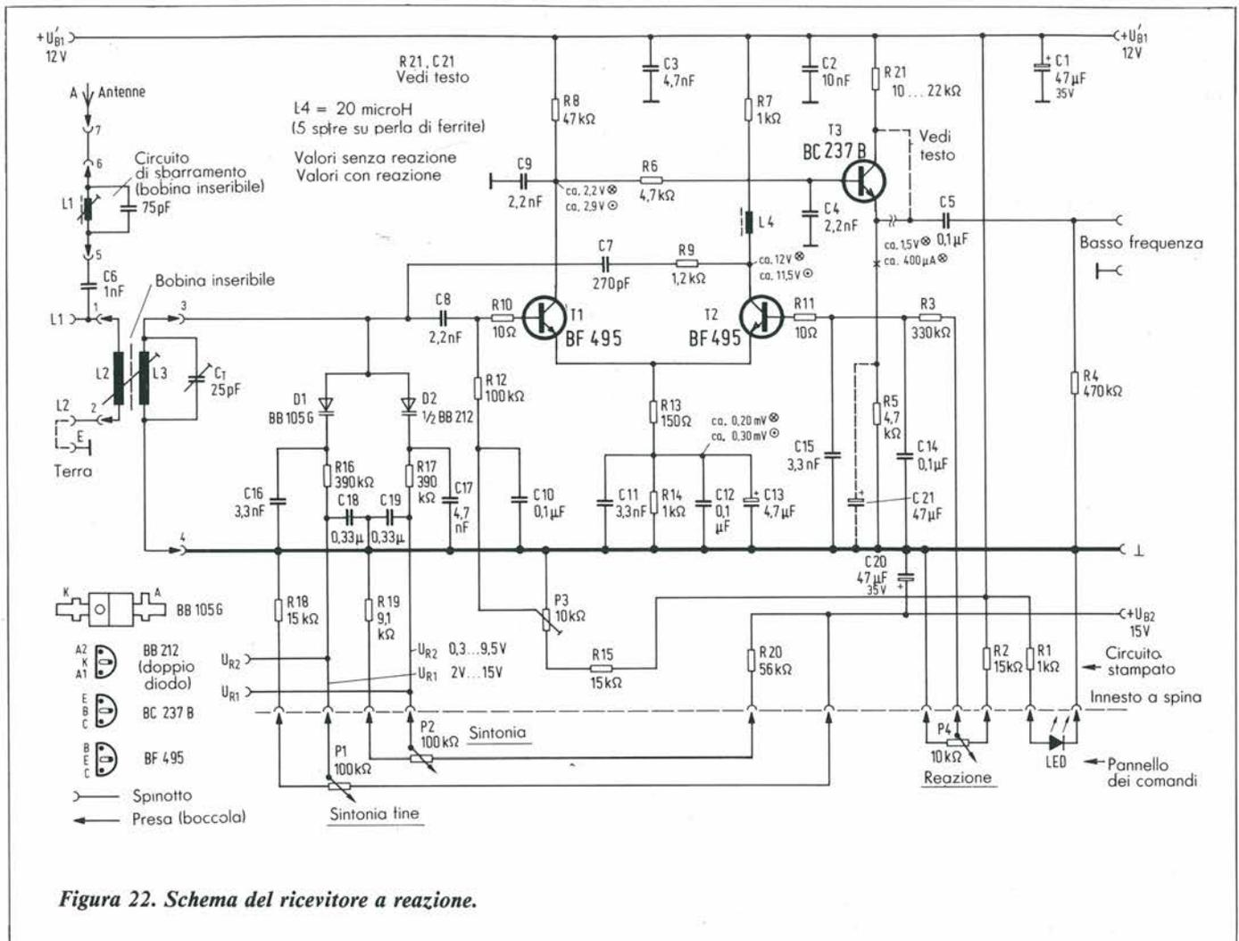
denza a queste frequenze aumenta la sua  $R_L = \omega L$ . In questo modo aumenta la tensione di reazione. In pratica, verrà impiegata una perla di ferrite ad un solo foro, oppure una bobina con circa 30 spire avvolte su un diametro di circa 4 mm. Non avendo a disposizione una tale perla di ferrite, la bobina potrebbe, in definitiva, essere eliminata.
