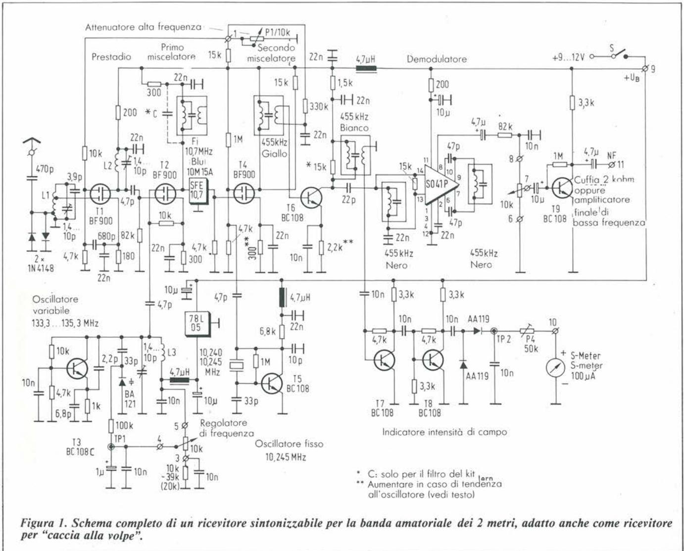
Figura 1. Schema completo di un ricevitore sintonizzabile per la banda amatoriale dei 2 metri, adatto anche come ricevitore per "caccia alla volpe".
