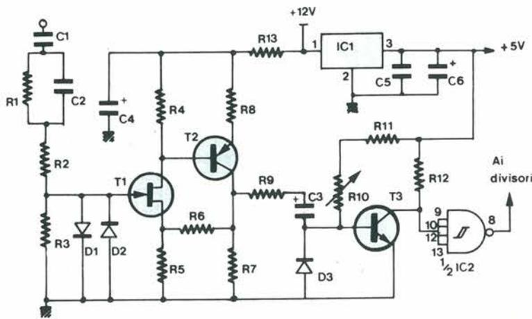
Figura 4. Circuito amplificatore e correttore di forma d'onda.
