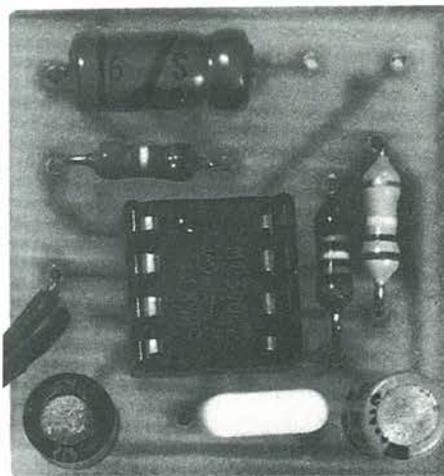
FIGURA 1: La suoneria elettronica assemblata
