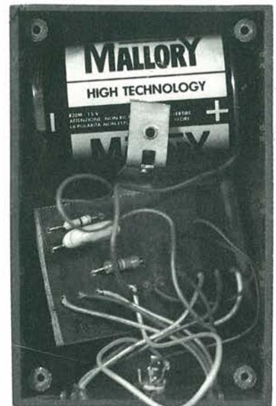
Figura 4: Il prototipo realizzato e alloggiato in un piccolo contenitore di plastica. Si scorge la batteria da 1,5V utilizzata per l'alimentazione.
