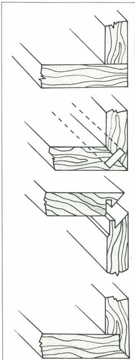
Figura 1. Vari tipi di giunzione: si va dal semplice accostamento dei pannelli sino ad incastrati molto sofisticati.
