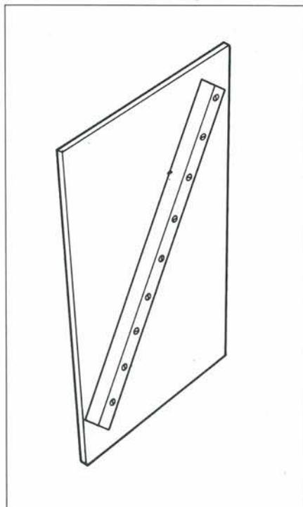
Figura 4. Un listello di cm 5x7 di sezione, incollato e avvitato trasversalmente al pannello, come rinforzo.
