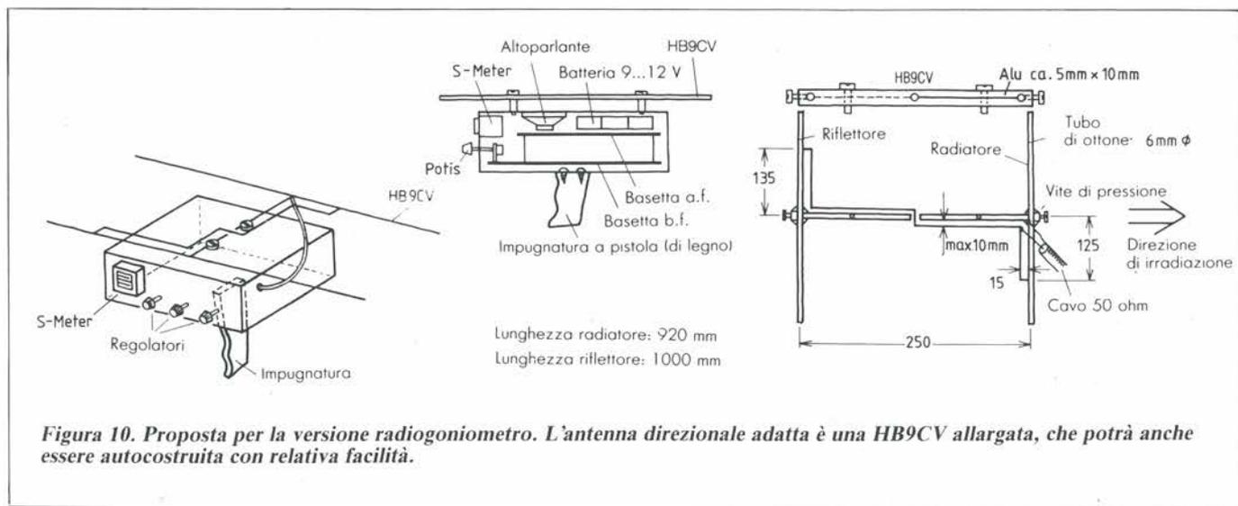
Figura 10. Proposta per la versione radiogoniometro. L'antenna direzionale adatta è una HB9CV allargata, che potrà anche essere autoconstruita con relativa facilità.
