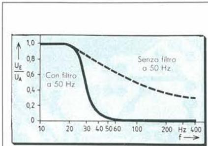
Figura 3. Risposta in frequenza dell'amplificatore. Il filtro a 50 Hz sopprime il ronzio indotto dai campi a tensione di rete.
