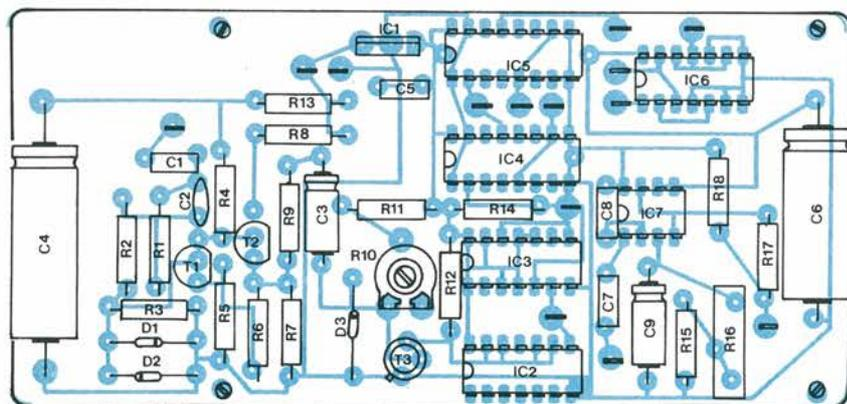
Figura 8. Disposizione dei componenti sul circuito stampato.
